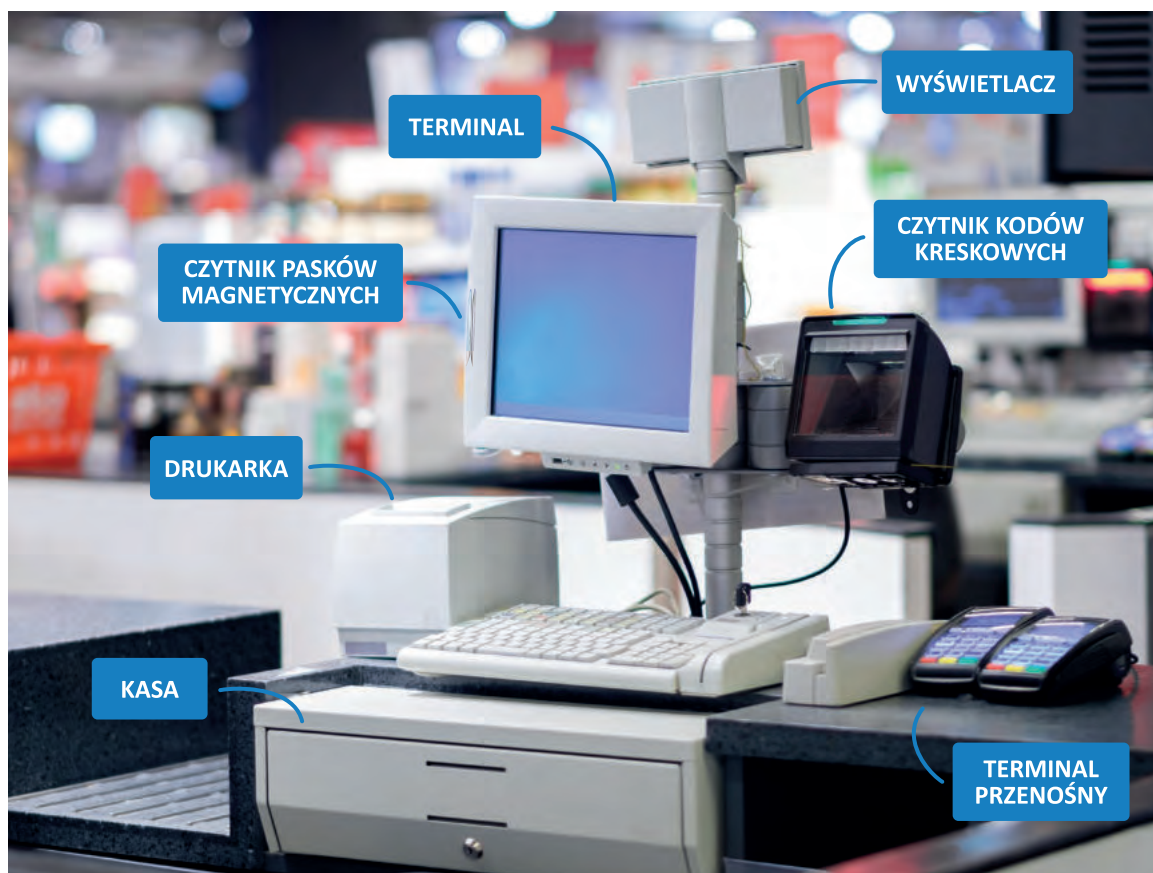
Fotografia 3. Typowy zestaw terminala POS, który można spotkać w punktach handlowo-usługowych, np. w restauracjach 16
